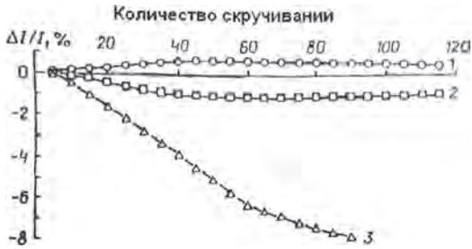
Рис. 1. Диаграммы относительного изменения длины образца при скручивании
